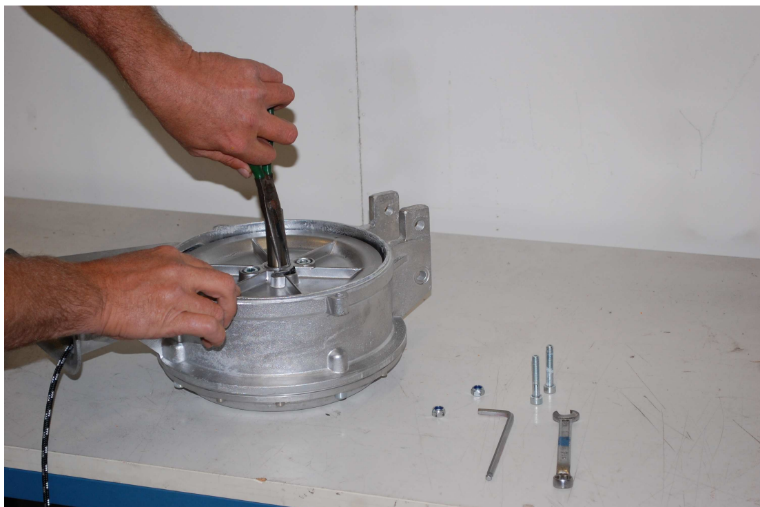
14.Dra ut snoren, bruk en spisstang eller lignende for å trekke ut knuten.
